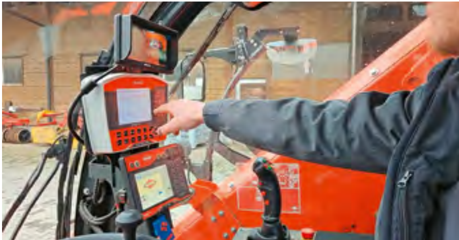
Entièrement vitrée, la cabine «Visiospace» abrite le boîtier du dispositif de pesée «PTM Advance» et le terminal de commande «VTI 60 T».
