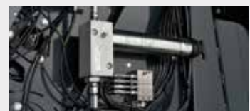
Système de graissage automatique des roulements (cartouche de 400 g)
