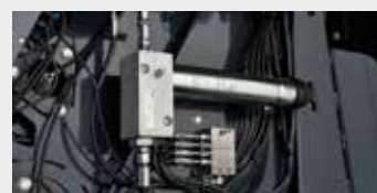
Système de graissage automatique des roulements (cartouche de 400 g)
