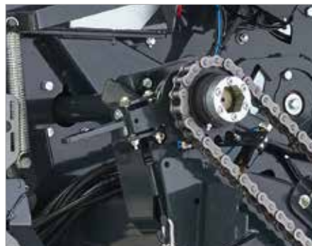
4. Débrayage mécanique du rotor
