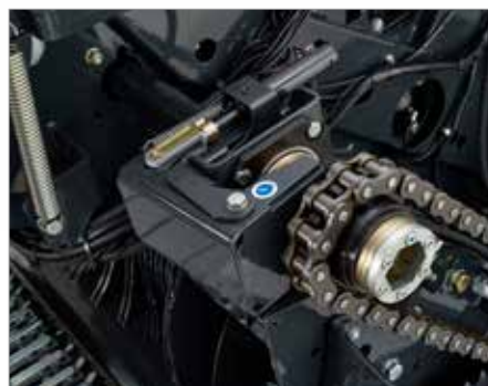
4. Débrayage hydraulique du rotor en cabine
