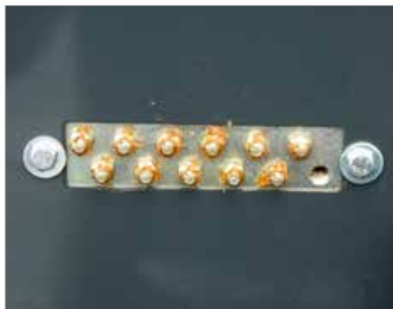
6. Réservoirs de graisse centralisés pour les roulements
