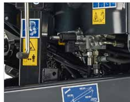
5. Contrôle de densité POWER LOCK
