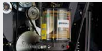
Système de graissage automatique pour les roulements (conteneur de 4 kg)
