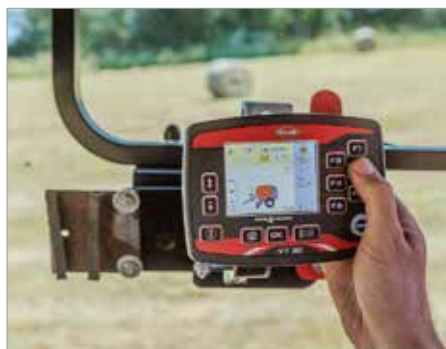
6. Présélection pour la commande du pick-up / de la trappe DROPFLOOR / des couteaux à partir du terminal
