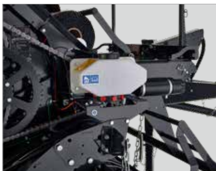
7. Système de lubrification automatique des chaînes
