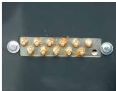
6. Réservoirs de graisse centralisés pour les roulements
