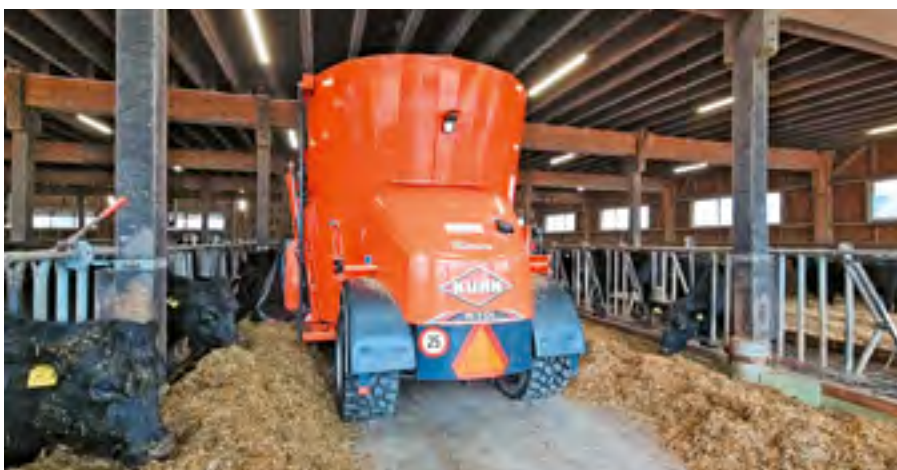
Dank schmaler Hinterachse wird das frisch abgelegte Futter nicht überfahren.
