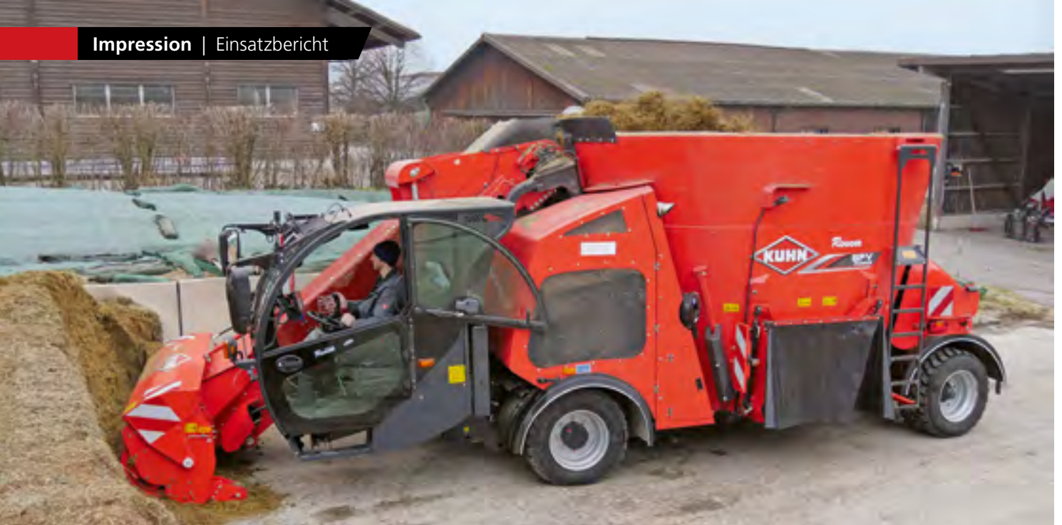
Der Kuhn «SPV Power 15.1 DL» auf dem Betrieb Murimoos. Durch die Platzierung des Mischbehälter zwischen den beiden Achsen ergibt sich für den «SPV»-Selbstfahrer eine kompakte Bauweise mit niedriger Gesamthöhe. Bilder: Heinz Röthlisberger
