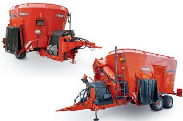
**Gezogene Futtermischwagen mit 1, 2 oder 3 Vertikal-schnecken von 8 bis 45 m<sup>3</sup> Fassungsvermögen**
