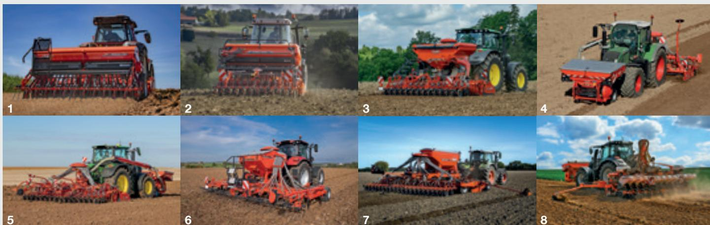
1. Mécaniques portés - 2. Mécaniques intégrés - 3. Intégrés pneumatiques - 4. Avec trémie frontale - 5. Repliables pneumatiques - 6. Portés pour semis simplifiés - 7. Traînés pour semis simplifiés - 8. Monograines
