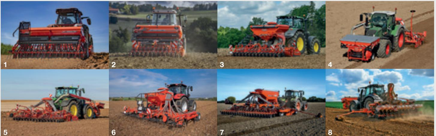
1. Mechanische Anbaudrillmaschinen - 2. Mechanische Aufbaudrillmaschinen - 3. Pneumatische Aufbaudrillmaschinen - 4. Drillmaschinen mit Fronttank - 5. Klappbare pneumatische Drillmaschinen - 6. Anbau-Mulchsaatmaschinen - 7. Gezogene Universaldrillmaschinen 8. Einzelkornsämaschinen
