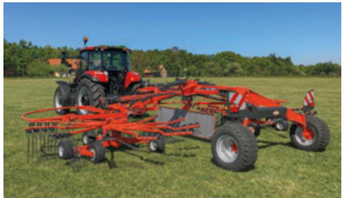
Durch Auswahl eines Tandem-Fahrwerks am Kreisel sind es 6 Räder, die nahe an den Zinken angebaut sind. Eine optimale Boden Anpassung ist garantiert!
