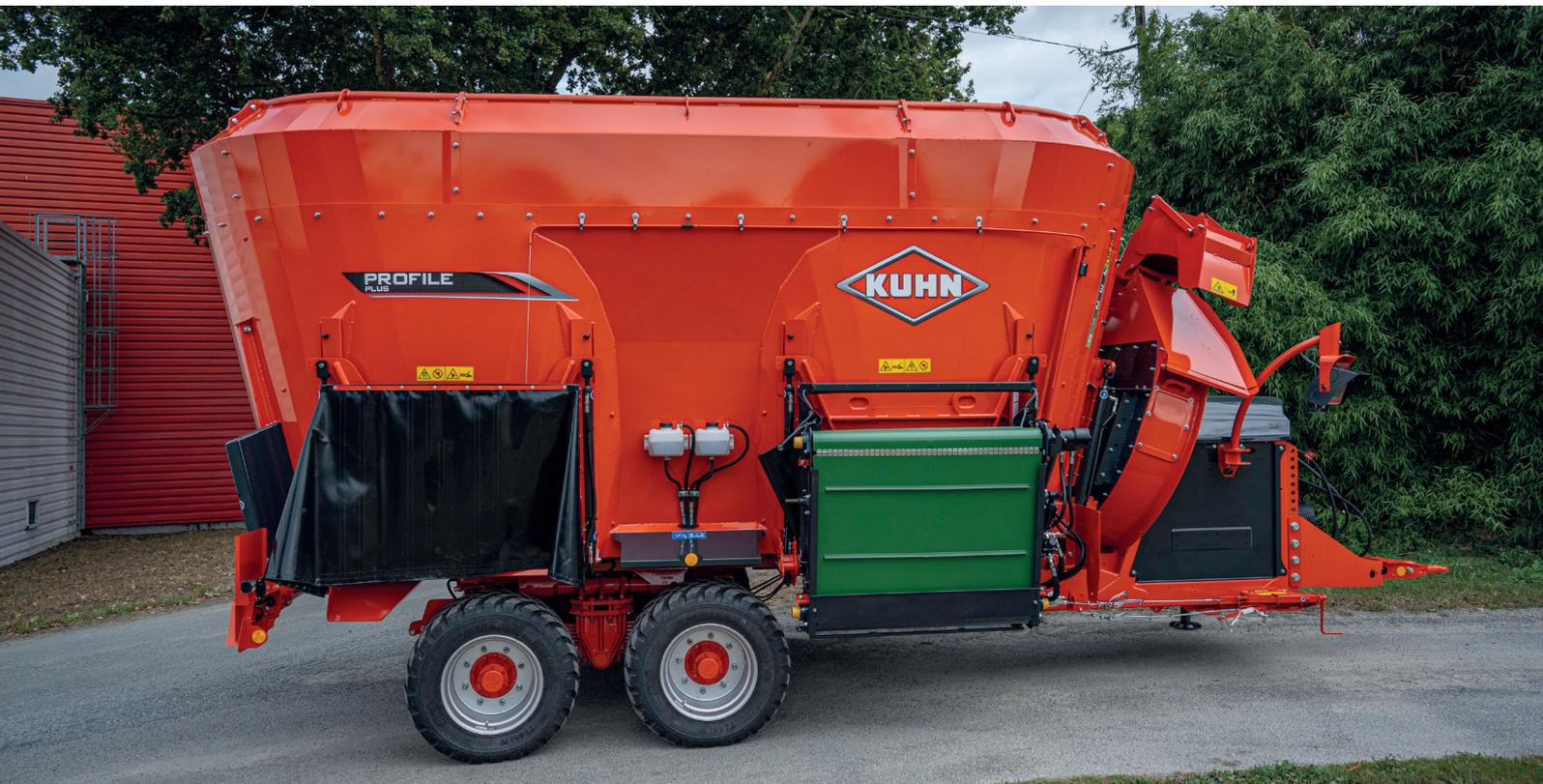
Die Behälterkonzeption - ein echter Kompromiss zwischen Breite und Höhe sowie die Form der Mischschnecken - sorgt dafür, dass diese neue Baureihe einen sehr hohen Füllfaktor hat. Und das alles bei einer geringen Gesamthöhe.
