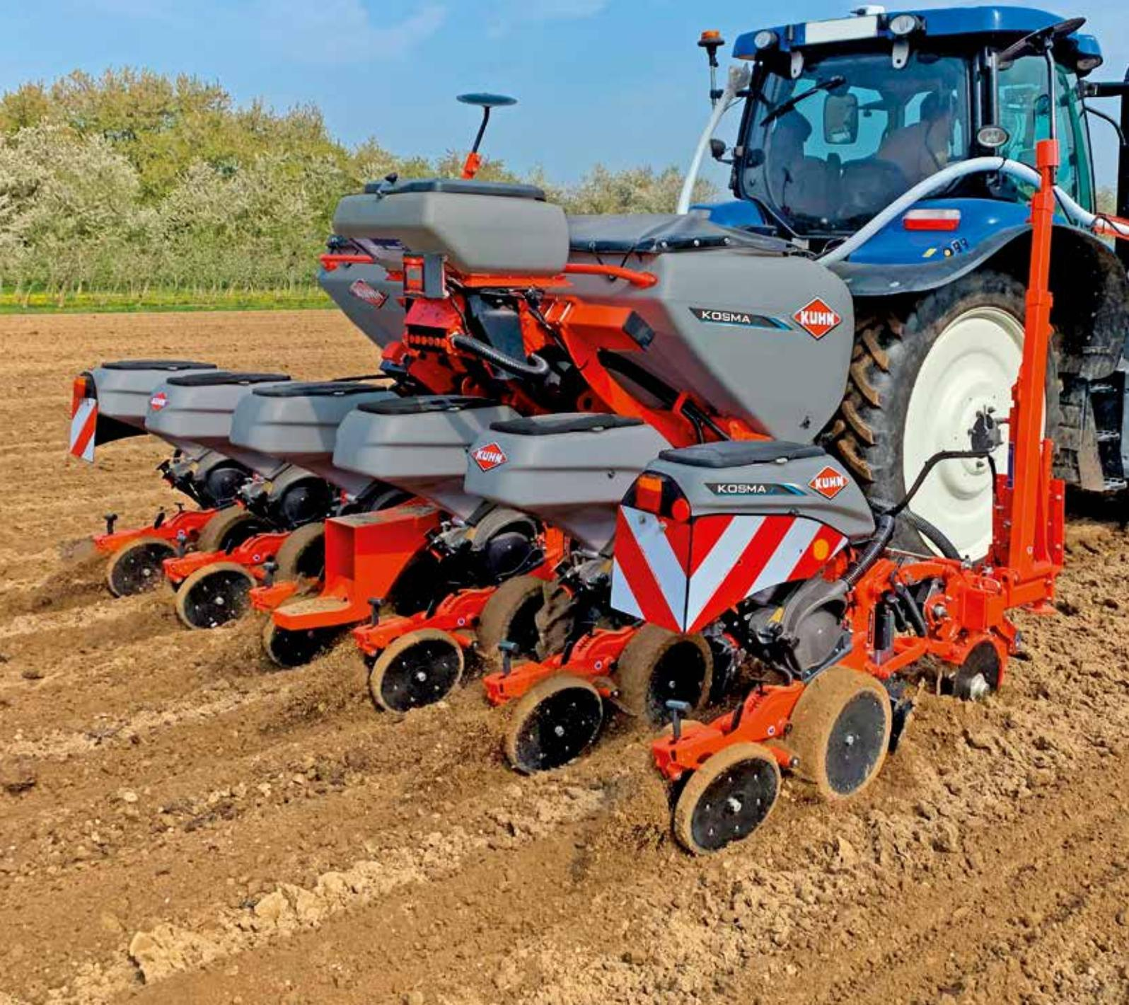
Ausgelegt auf eine Straßentransportbreite von 3 Metern, bietet dieser Rahmen die Möglichkeit, mit 6 Reihen bei einem Abstand von 75 cm in der Ausführung KOSMA zu säen. In der Ausführung MAXIMA 3 ist der Rahmen größer bemessen, so dass genügend Platz für einen 1350 Liter Düngertank vorhanden ist. Es kann mit bis zu 6 Reihen bei einem Abstand von 80 cm gesät werden.
