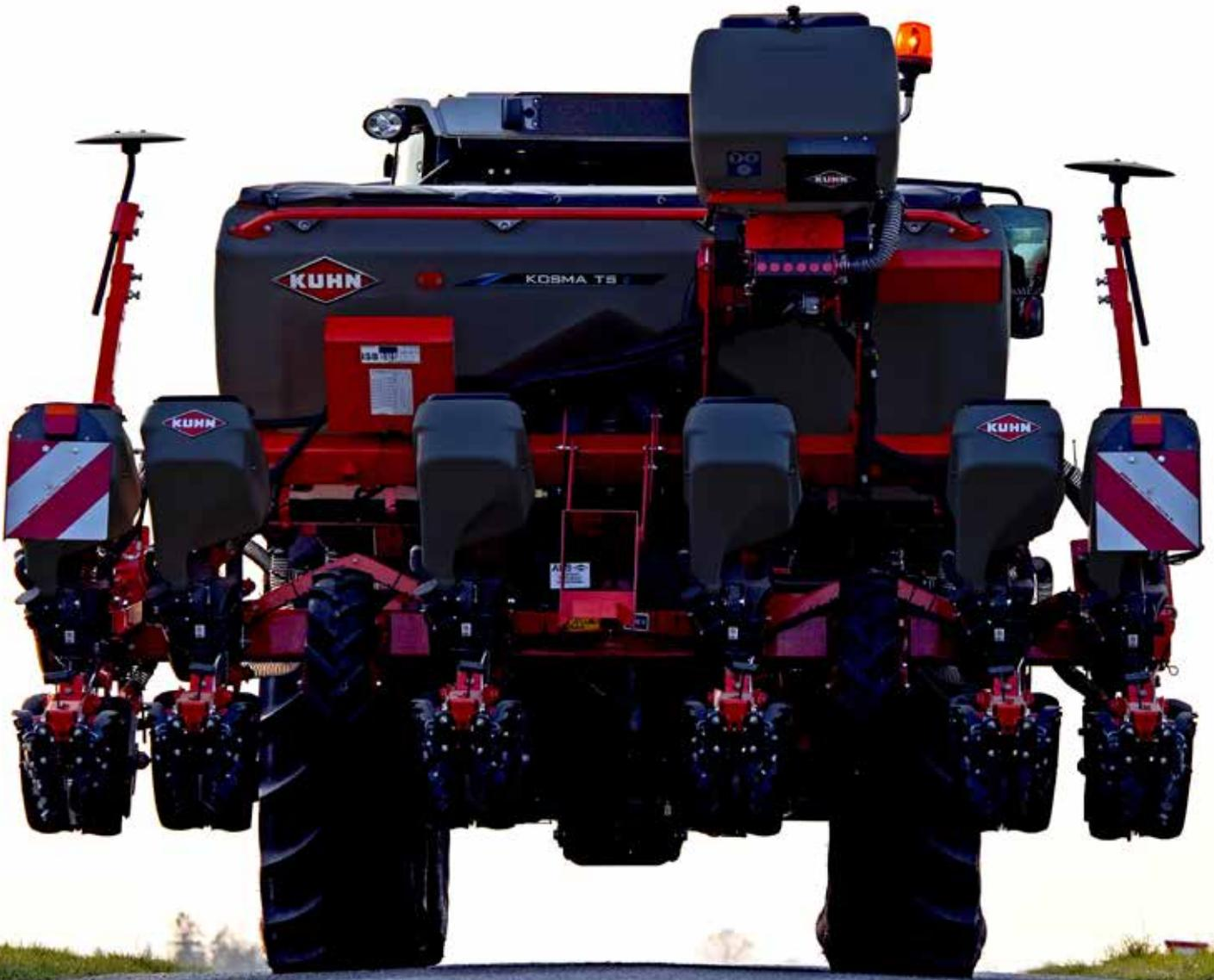
Arbeitsbreiten bis zu 4,5 Meter und als 3,3 bis 3,5 Metern Transportbreite je nach Reihenweite - das ermöglicht der einfache Teleskoprahmen durch eine robuste Schiebevorrichtung. Dieser Best-Seller verdankt seinen Erfolg der Robustheit und Einfachheit des Teleskopsystems.
