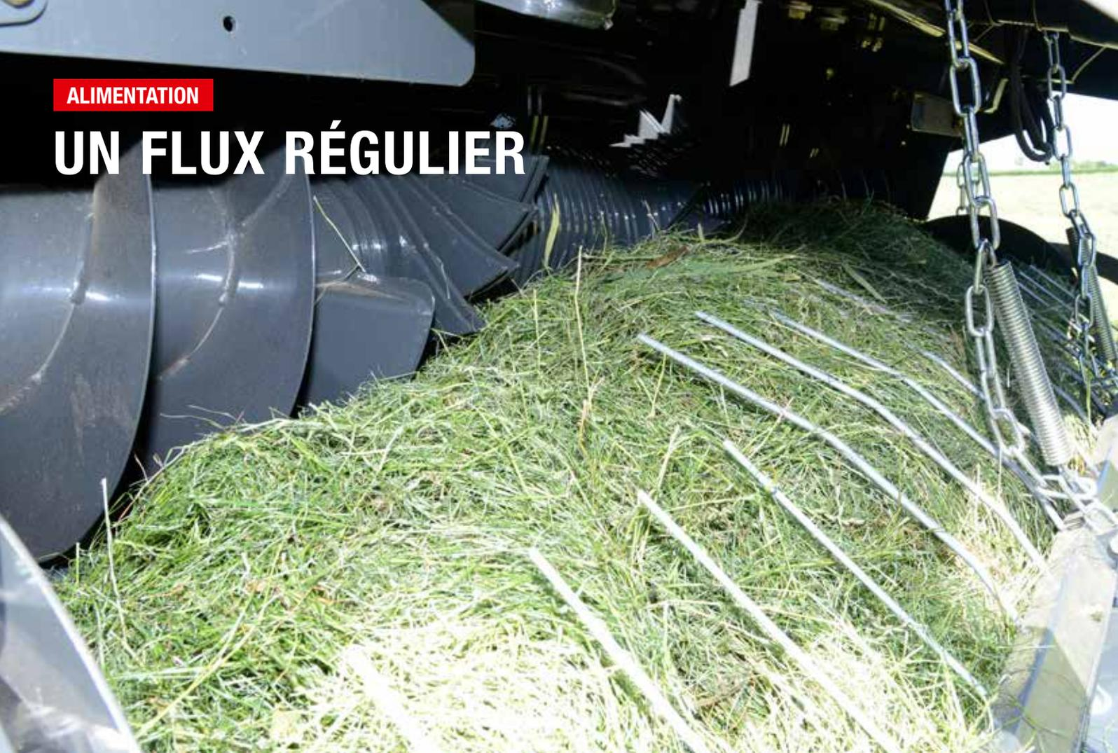
Les presses KUHN FB assurent une alimentation régulière en fourrage. Le large pick-up s'adapte parfaitement aux variations du sol. Son dispositif pendulaire permet une intervention dans les conditions les plus rudes.
