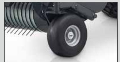
Roues de pick-up pivotantes semi-pneumatiques
