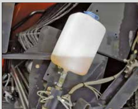
Pour que les chaînes aient une longue durée de vie, les presses FB de KUHN peuvent être équipées d'un système de lubrification continue, activé à chaque cycle de liage.
