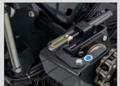
Débrayage hydraulique du rotor
