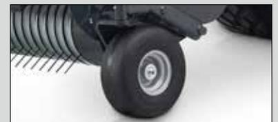
Roues de pick-up pivotantes semi-pneumatiques
