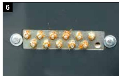
Réservoirs de graisse centraux pour les roulements
