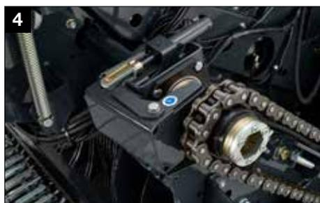
Débrayage hydraulique du rotor
