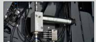
Système de graissage automatique des roulements
