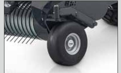
Roues de pick-up pivotantes semi-pneumatiques
