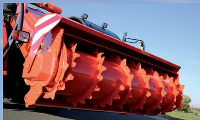
Fraise de chargement adaptée à tous les fourrages (Puissance : 90 à 120 ch)
