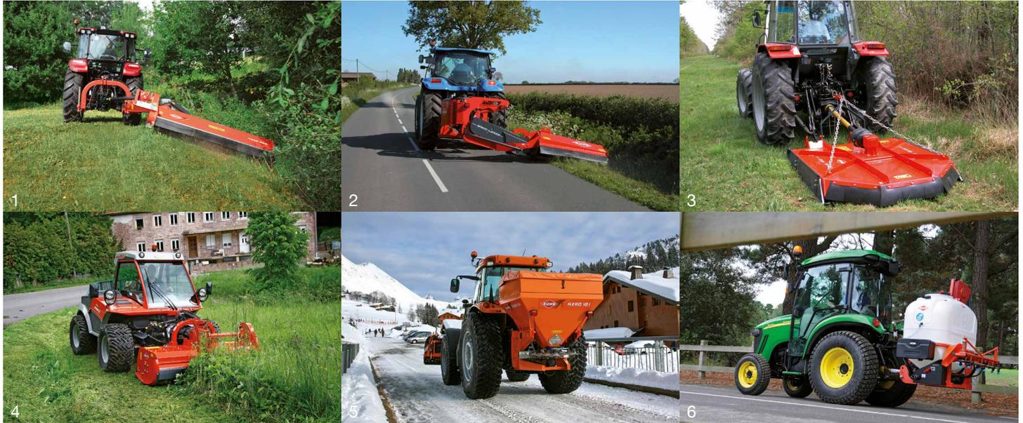
1. Böschungsmulcher mit 1,61 bis 2,49 m - 2. Randstreifenmäher mit 1,60 bis 2,30 m im Front- und Heckanbau -
