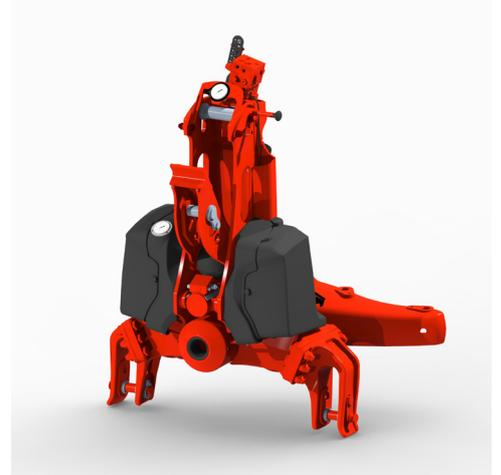
L'avant-train OptiDrive apporte, en plus de la simplification du passage travail/transport, un système d'amortissement des chocs. Complètement intégré dans la structure de l'avant-train, la suspension améliore considérablement le confort du conducteur durant les phases de retournement et au transport tout en protégeant la charrue et le tracteur.
