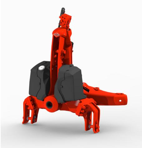
L'avant train de la VARI-MASTER L est disponible en catégorie 3N, 3 et 4N. L'attelage de la charrue se fait en toute simplicité à l'aide des mains d'attelage fixes. Sans aucune intervention lourde, il est dorénavant possible d'ajuster facilement la hauteur des points inférieurs d'attelage pour optimiser la traction du tracteur.
