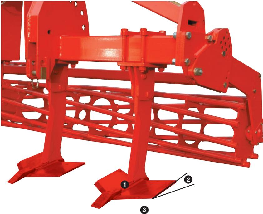
**1** L'ameublissement de la zone compacte : l'effet de « vague » généré par les dimensions spécifiques des socs restructure le sol par soulèvement et entraîne sa chute derrière le soc.
