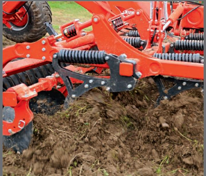
Durch die gewundene Form des Abweisers bewirkt der Zinken eine optimale Verteilung von Feinerde, Stroh sowie Erdkluten und dies bei geringem Leistungsbedarf.
