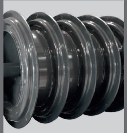
**T-Liner-Walze:** Die vielseitige leichte Walze für steinige und feuchte Böden. Ähnlich aggressiv wie die T-Ring-Walze. Durchmesser 600 mm und 140 kg/m. Aus vergütetem Stahl zum Schutz vor Stoßbelastungen und Verschleiß.
