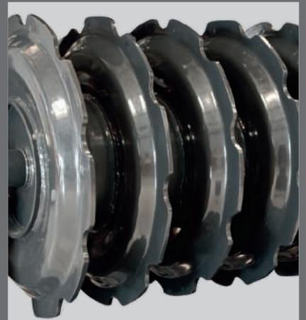
**HD-Liner 600:** Schwere Walze für intensive Rückverfestigung über die gesamte Breite. Das V-Profil leitet die Kräfte nach unten und zur Seite, so dass eine konstante Rückverfestigung über die gesamte Walzenbreite erfolgt. Durchmesser 600 mm und 180 kg/m. Aus vergütetem Stahl zum Schutz vor Stoßbelastungen und Verschleiß.
