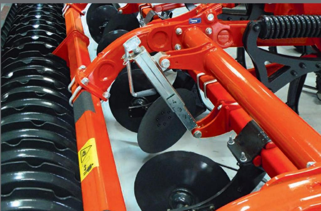
Die Einstellung der Einebnungsscheiben erfolgt zentral über eine Handkurbel. Die seitlich einstellbaren Randscheiben ermöglichen einen tadellosen Anschluss an die nächste Überfahrt.
