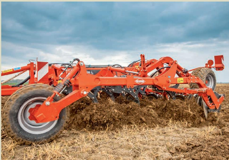
Der Durchgang von 85 cm unter dem Rahmen erlaubt den Einsatz auch bei hohem Anteil an Ernterückständen.
