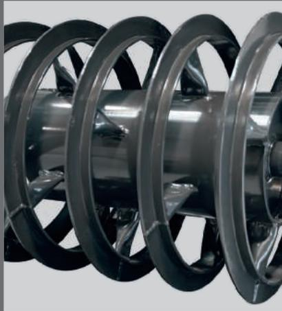
**T-Ring-Walze:** Leichte Walzenausführung zum aggressiven Zerschlagen von Erdkluten und Strohrückständen. Schaffung eines rauen Bodenprofils. Ideal für Lehmböden. Durchmesser 600 mm und 130 kg/m.
