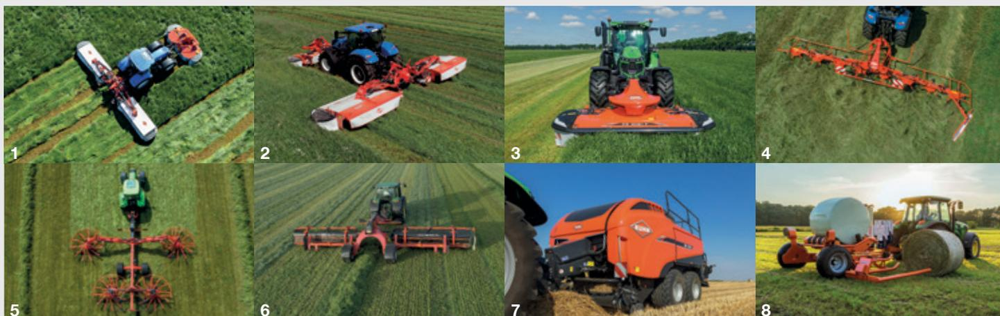
1. Faucheuses à disques - 2. Faucheuses-conditionneuses à disques - 3. Faucheuses à tambours - 4. Girofaneurs - 5. Giro-andaineurs - 6. Andaineurs à tapis - 7. Presses - 8. Enrubanneuses
