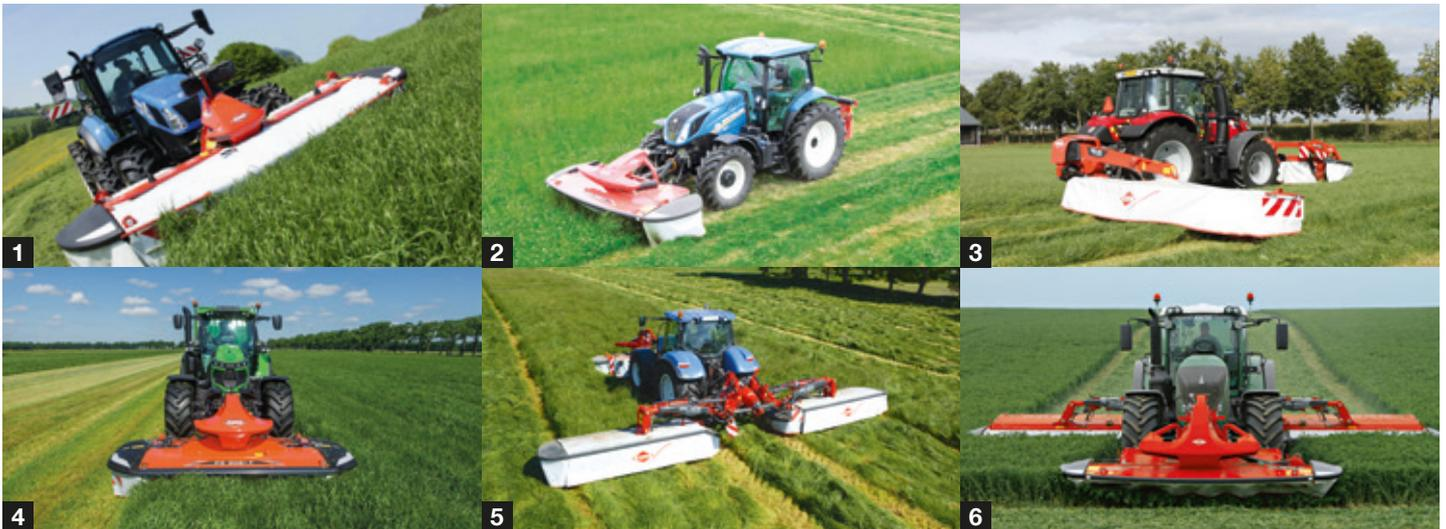
1. Faucheuses à disques frontales compactes - 2. Faucheuses à disques frontales - 3. Faucheuses à disques à repliage horizontal - 4. Faucheuses à tambours frontales / arrière - 5. Faucheuses à disques triple - 6. Faucheuses-conditionneuses à disques triple.
