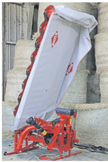
L'attelage optimisé permet une bonne adaptation aux différentes largeurs hors-tout des tracteurs. La géométrie du châssis et de l'entraînement réduit au minimum l'encombrement au transport. Le protecteur d'extrémité se replie automatiquement pour réduire la hauteur de transport (sur GMD 315 et 355). La machine est déposée à plat lors du remisage. Si la place disponible est limitée, une béquille additionnelle (option) permet la dépose en position verticale dans votre hangar.
