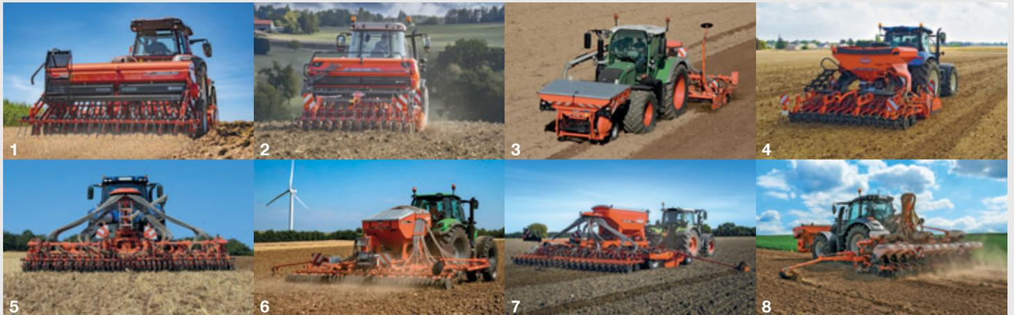
1. Mécaniques portés - 2. Mécaniques intégrés - 3. Avec trémie frontale - 4. Intégrés pneumatiques - 5. Repliables pneumatiques
