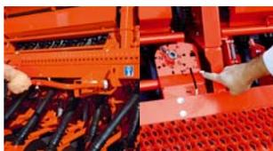
Simple et centralisés à l'arrière de la machine, ces réglages sont confortables et rapidement exécutés grâce à une manivelle. Un indexage permet de visualiser les réglages et facilite ainsi l'utilisation de la machine.
