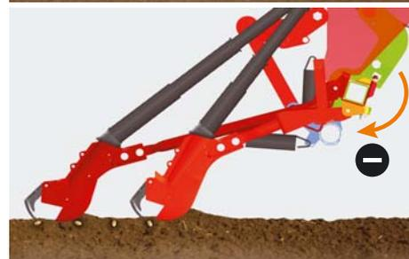
Positionnement de la butée basse pour une profondeur de semis de 8 cm et 1 cm.
