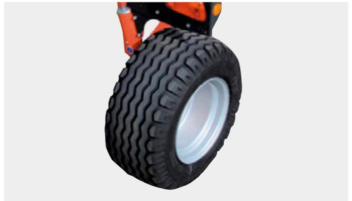
Réduisez le tassement au sol avec les roues larges et n'excédez pas 3,00m de largeur de transport.
